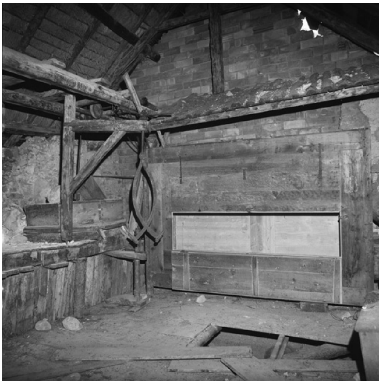
Moulin communal. Système pour soulever les meules et bluttoir.
